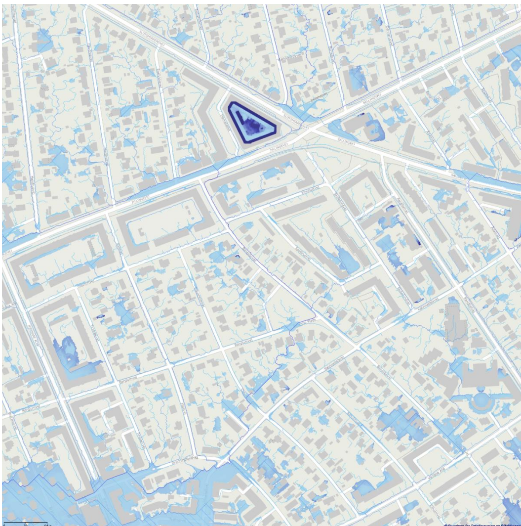
Figur 2: Hydraulisk kort, der viser tilstrømninger og oversvømmelser ved større skybrud.
